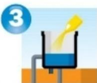
**3** Ingresar agua en el tanque hasta 20-30 cm. de altura y agregar agua lavandina concentrada (dos litros de agua lavandina por cada 500 litros de capacidad del tanque). Utilizar solamente agua lavandina que contenga en su composición hipoclorito de sodio (sin fragancias).
