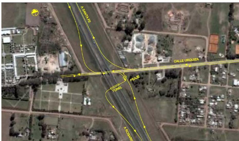
Esta obra debe incluir además de la ejecución de las ramas de conexión entre la AUTOPISTA y calle Urquiza, la pavimentación de esta calle como mínimo en el ancho de zona de camino de la AUTOPISTA. Las ramas de conexión deberán ser similares a las existentes en el resto de los intercambiadores de la AUTOPISTA.
