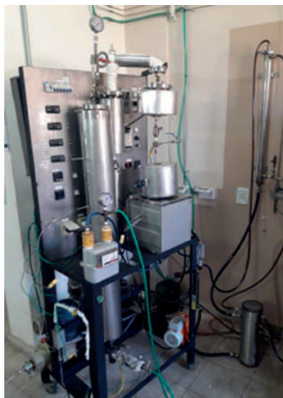
IMAGEN 1. Gasificador a escala banco (INCAPE-Conicet)
