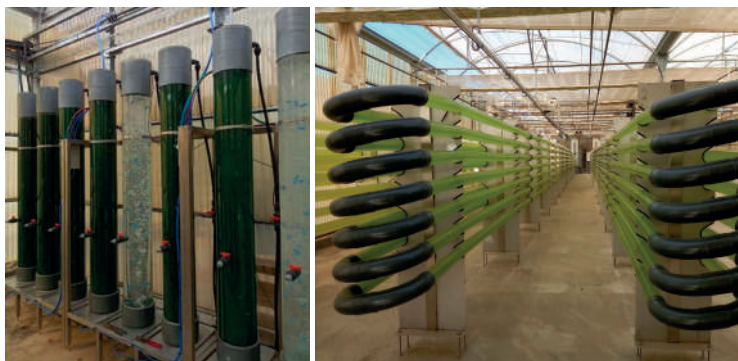
FIGURA 10. Sistema de columnas y sistema tubular exterior en IFAPA. Ambos se encuentran en un invernadero de cultivos sin control de temperatura. Tres columnas se usan para alimentar el reactor tubular.
