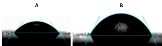
FIGURA 2. Micrográficas de gotas de agua de 2 \mu\text{l} en la superficie de a-MCC y b-MCCAc.
