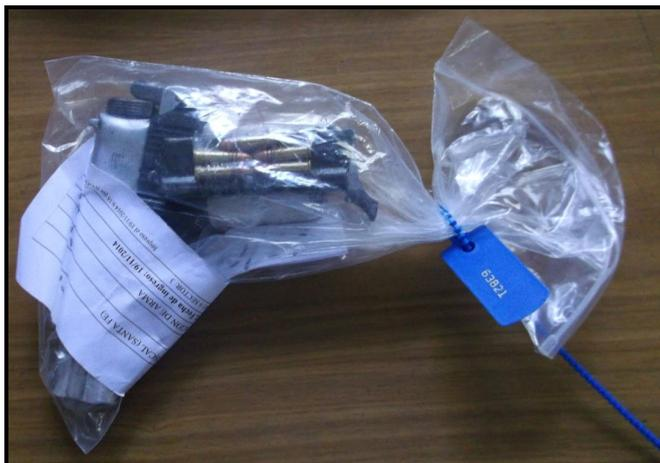
Se sugiere inmovilizar cartucho mediante cinta adhesiva, a los fines de evitar roces, golpes y facilita la observación y conteo
