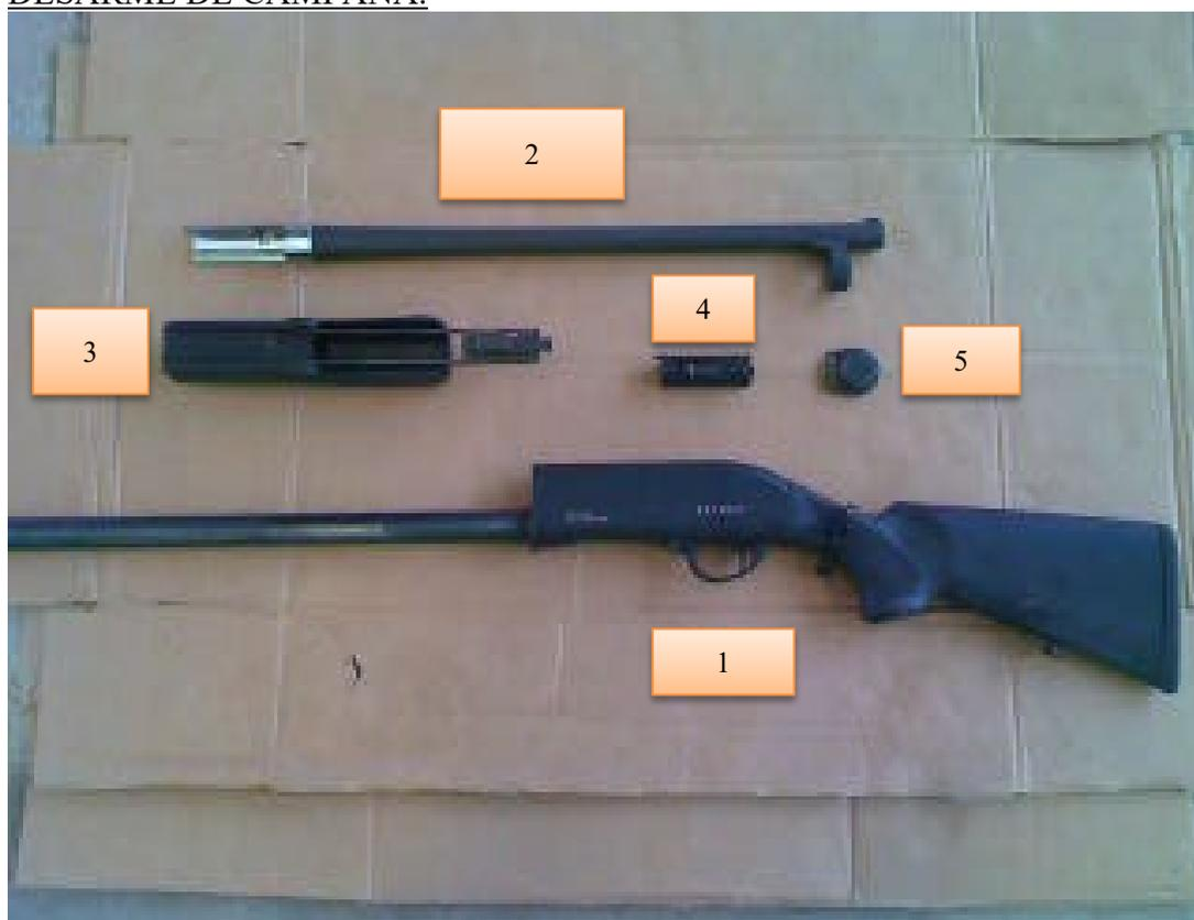
1- Cajón de mecanismo, tubo almacén cargador, culata, cantonera, arco guardamonte, cola del disparador y seguro manual transversal.
