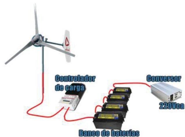
Figura 14. Componentes de un aerogenerador de baja potencia.
