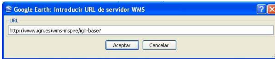
Figura 14.21.- Ventana para añadir la URL de un servicio WMS en Google Earth
