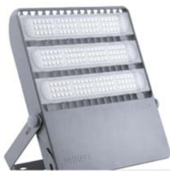
L08: Proyector Philips - Tango G3 - BVP383 LED455/CW 220-240V AMB GM - 45500lm - 5700K° - 350w - Medidas: 603 x 593 x 114 mm. Se deberá incluir en la oferta soporte de 8 y 2 equipos según se indica en planimetría, diseño y calculo.
