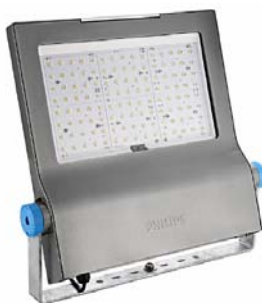
L09: Proyector Philips - ClearFlood - BVP650 LED120-4S/740 PSU S ALU 12000lm - 4000K° - Medidas: 562 x 580 x 95 mm. Se deberá incluir en la oferta el soporte de 1 equipo, según se indica en planimetría, diseño y calculo.
