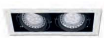
L07: Empotrable de Cielorraso Modelo SPACE Marca LUCCIOLA Cod: ET.022/1 1x15W Blanco Calido. Color Luminaria Aro BLANCO. Medida: 200x200mm.
