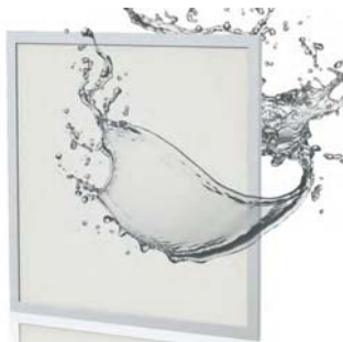
L06: Panel Empotrable de Cielorraso cuadrado. Modelo: PANEL WATER Marca LUCCIOLA Cod: PAL206 48W. 4.300 LUMENES. Color 4.000 °K. IP65. Luminaria Blanca. Medida: 605x605mm.
