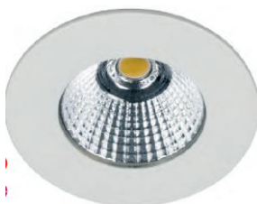
L04: Empotrable de Cieloraso Circular Modelo HERMES II Marca LUCCIOLA Cod: ETL520. Lampara LED 7w 570 LM. 3000 °K. medidas: Diam 69mm. Luminaria Color Blanco.
