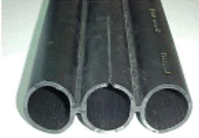
El ovalado de los tubos no será mayor que 2 mm en ninguna sección de los mismos. El ovalado de una sección recta cualquiera, será la diferencia entre el diámetro exterior medio en dicha sección y el diámetro máximo o mínimo de la misma.
